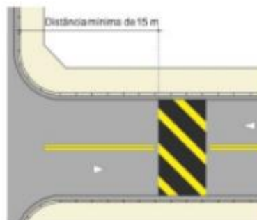
FIGURA 1: Distância mínima da lombada para a interseção
