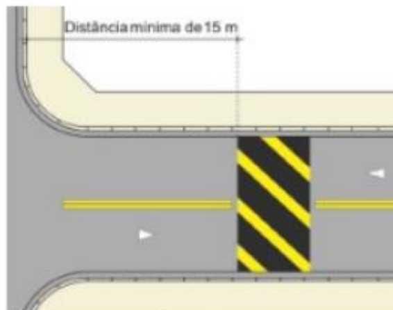
FIGURA 1: Distância mínima da lombada para a interseção
