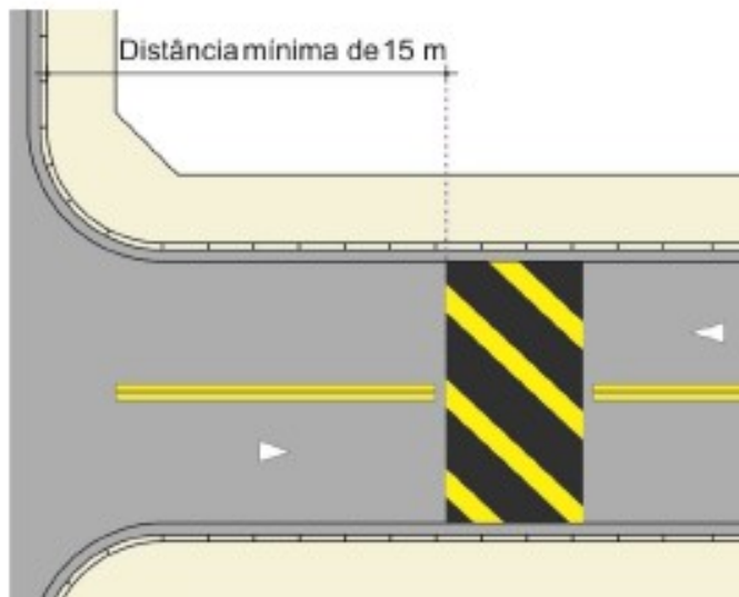
FIGURA 1: Distância mínima da lombada para a interseção
