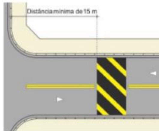
FIGURA 1: Distância mínima da lombada para a interseção
