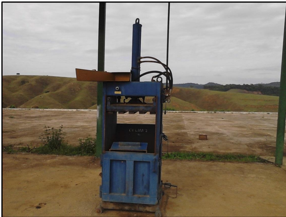
Figura 59 – Prensa desativada para resíduos sólidos sem motor.
