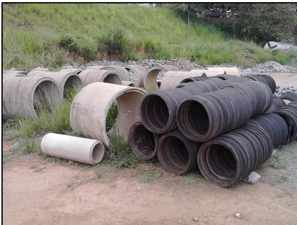
Figura 70 - Manilhas feitas de pneus usados por terceiros
