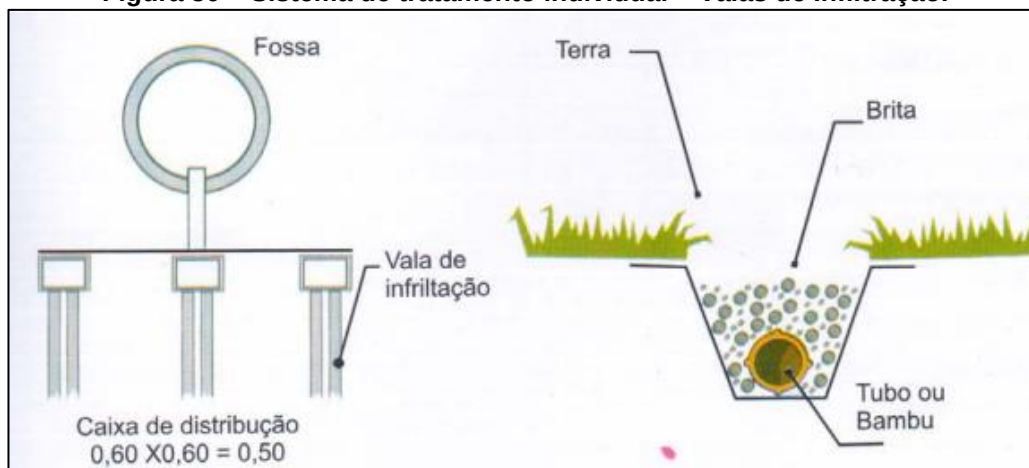
Figura 30 – Sistema de tratamento individual – Valas de Infiltração.
