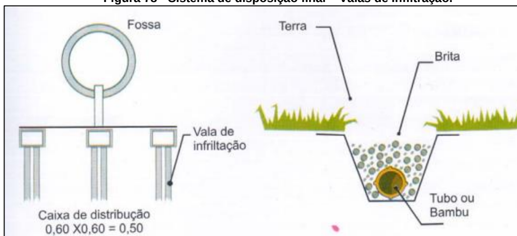
Figura 78 - Sistema de disposição final – Valas de Infiltração.
