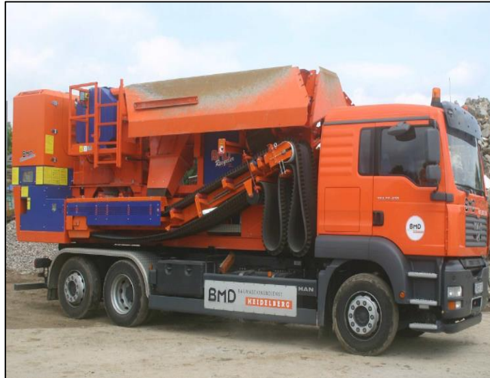
Figura 108 - Usina móvel de RCC.
