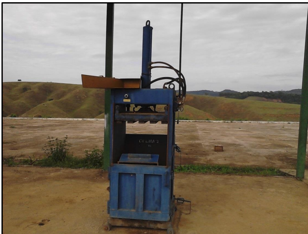
Figura 59 – Prensa desativada para resíduos sólidos sem motor.
