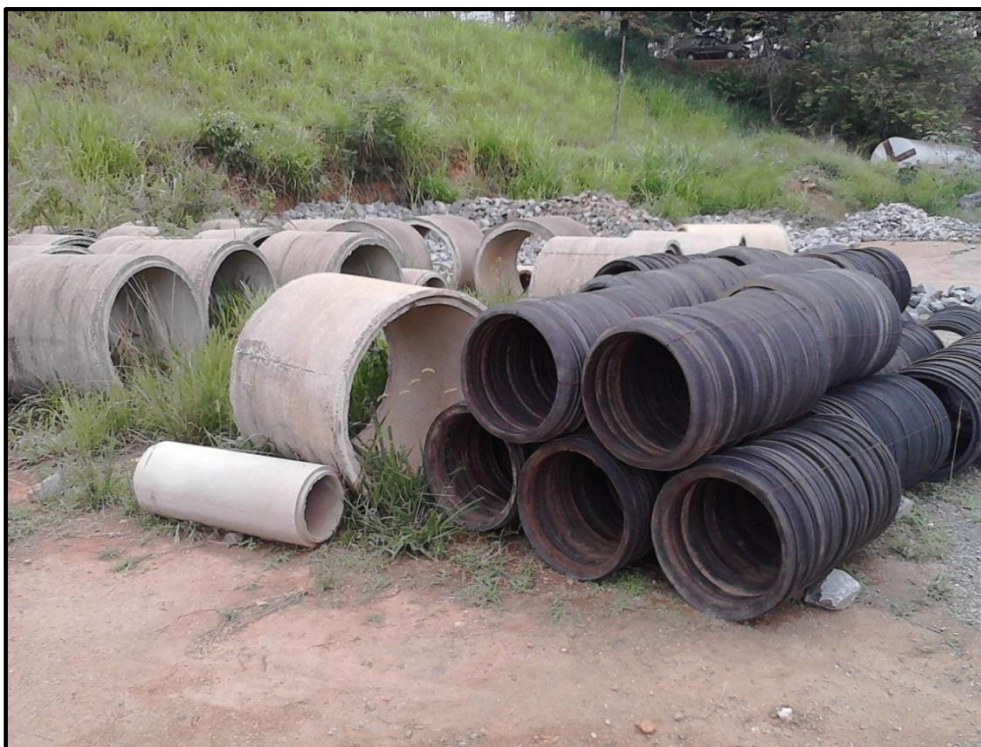
Figura 70 - Manilhas feitas de pneus usados por terceiros
