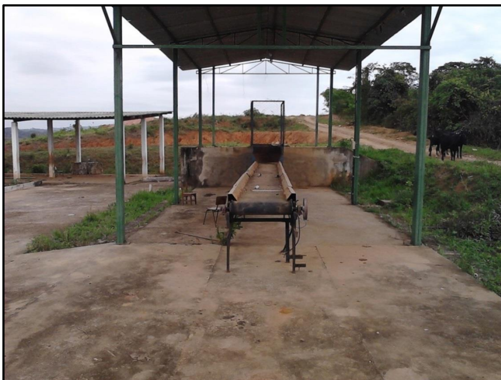
Figura 60 – Esteira destinada para transportar fados prensados.
