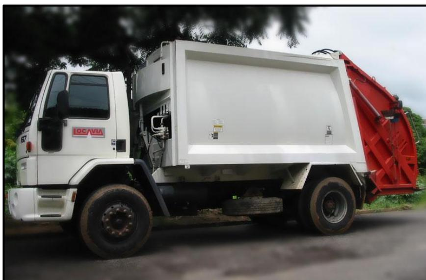
**Figura 8 - Modelo de Caminhão Compactador para coleta de lixo.**
