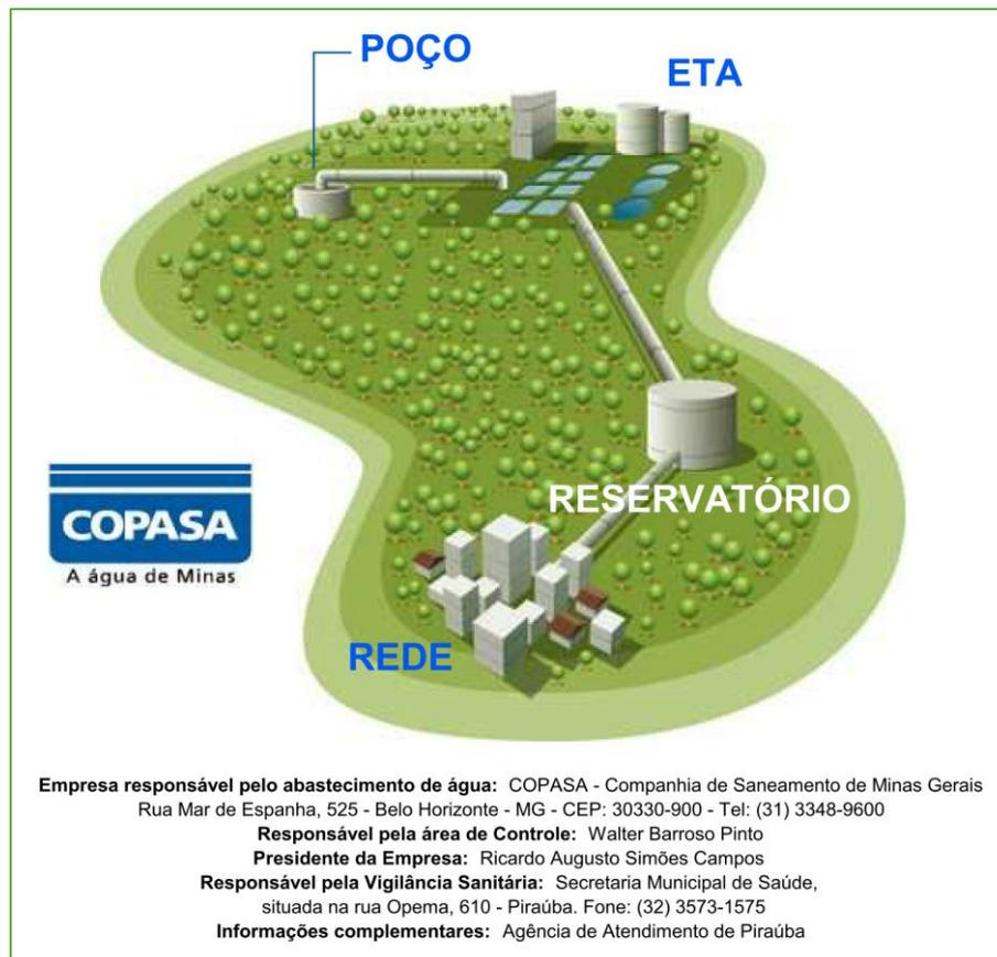
**Figura 3 - Esquema do Sistema de Abastecimento de Água do Município de Piraúba (FONTE: Relatório de Qualidade da Água 2013 – COPASA)**
